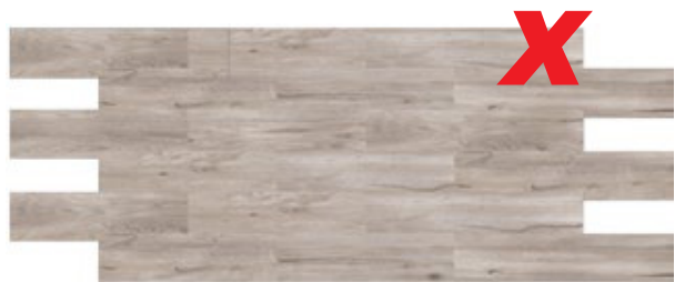
FIGURA 2 – Assentamento com juntas amarradas do tipo “tijolinho” em 50% da lateral da cerâmica, NÃO É RECOMENDADO PELA FÁBRICA.
