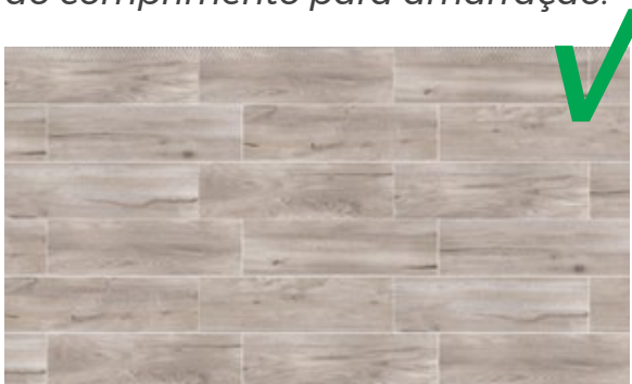
FIGURA 1 – Assentamento das placas com juntas desencontradas com no máximo de 20% da lateral da cerâmica
